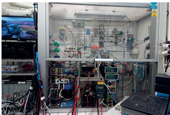
Experimentální sestava pro testování palivových článků a jejich komponent. Tato sestava umožňuje testování aktivity katalyzátorů, plynové difúzních elektrod i celých sestavených článků za různých provozních podmínek. Poskytuje tak informace o využitelnosti nově navržených řešení v praxi. Zároveň umožňuje získat vstupní data pro komplexní matematické modely určené k hlubšímu pochopení sledovaných procesů a zvětšení měřítka navrhovaných jednotek. Foto: Daniel Frank
