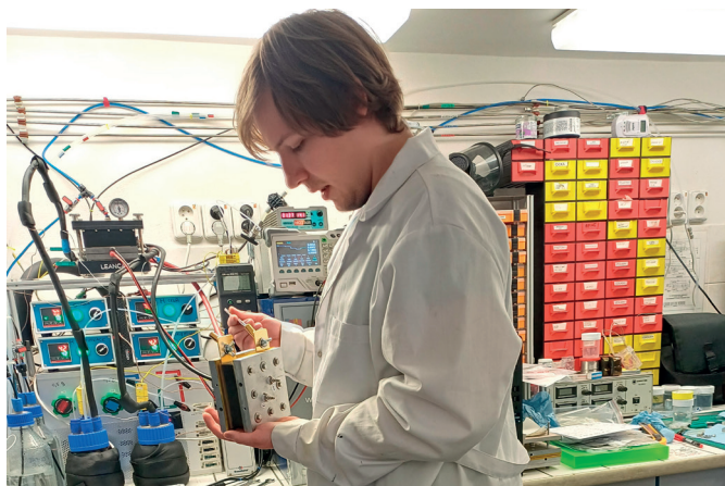
Ing. Tomáš Jedlička při demonstraci celého experimentálního palivového článku typu PEM v laboratoři VŠCHT zaměřené na vývoj a testování palivových článků. Tento pokročilý energetický systém využívá vodík k účinné výrobě elektřiny bez emisí oxidu uhlíkového. Foto: Daniel Frank
